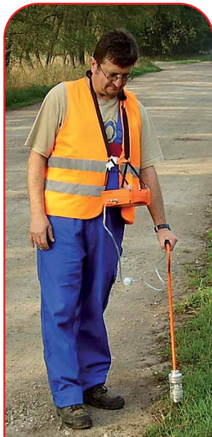
Bild : Prüfung der Bodenluft mit Stabsonde
