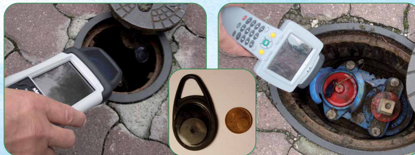
Bild : RFID-Transponder auf einem Schieber
